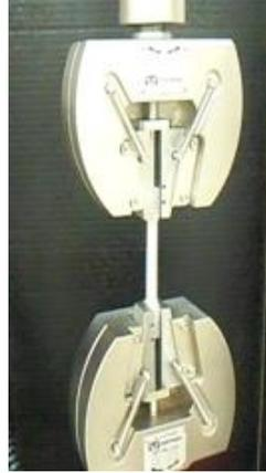
FIGURE 4. Dispositif de l'essai de traction uniaxiale
