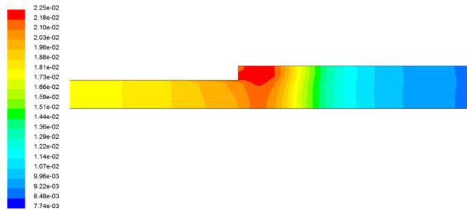
Figure 5. le contour de la fraction volumique (vapeur)
