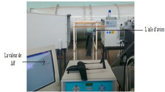
Figure 8. Le montage d'expérience dans la soufflerie
