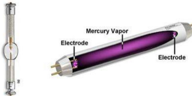
Lampe à vapeur de mercure. La lumière est émise après excitation du gaz par un arc électrique entre les deux électrodes.
