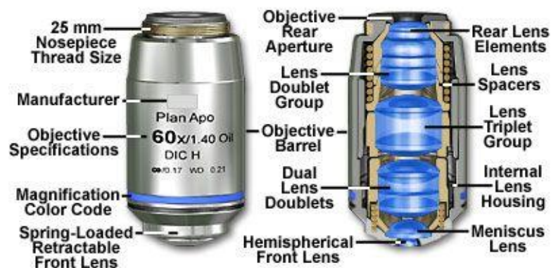
Exemple d'objectif à fort grossissement. La coupe à droite montre la complexité de la structure de ce type d'objectif.
