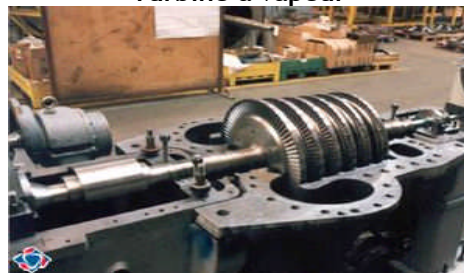
Turbine à vapeur
