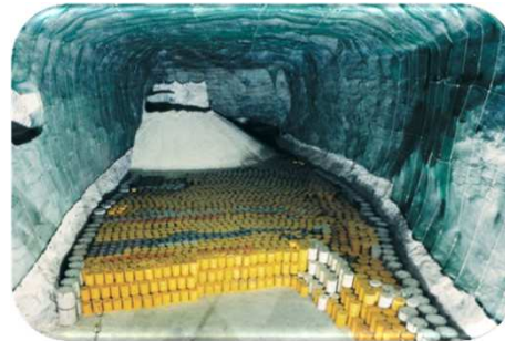
Le stockage des déchets réactifs
