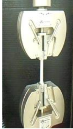
FIGURE 4. Dispositif de l'essai de traction uniaxiale
