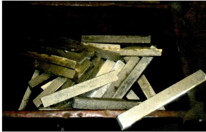
**Figure 1:** Photos des échantillons Cu-Sn<sub>10</sub> obtenus par le four à remous.
