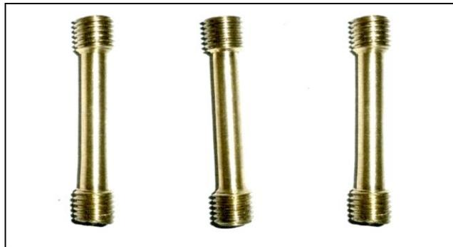
**Figure 2:** Photos des échantillons Cu-Sn<sub>10</sub> normalisées qui ont servi à l'essai de traction uniaxiale.
