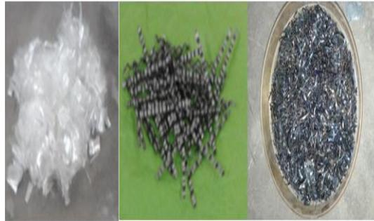
FIGURE 1. Fibres « polypropylène, ondulées d'acier, copeaux métalliques » utilisées dans le renfort des BAP
