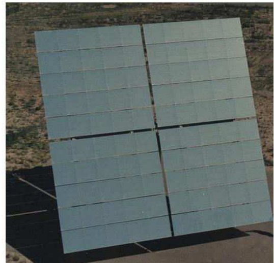
Fig. 05- Héliostat ATS h 150
