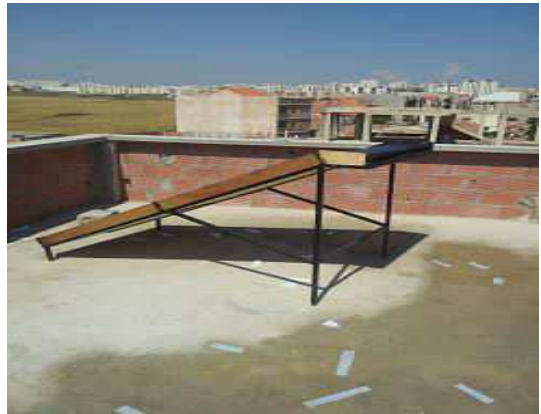
Figure 4 : capteur solaire à simple vitrage réalisée
