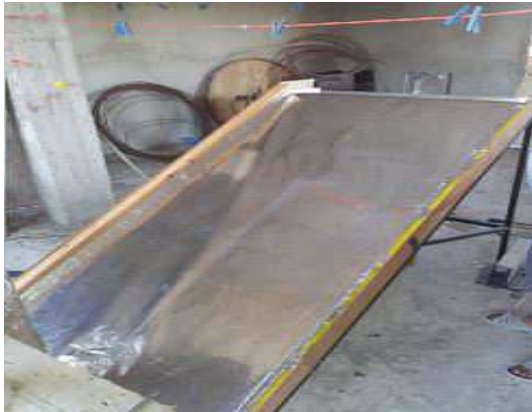
Figure 3 : Représentation d'un côté d'équipement du capteur solaire
